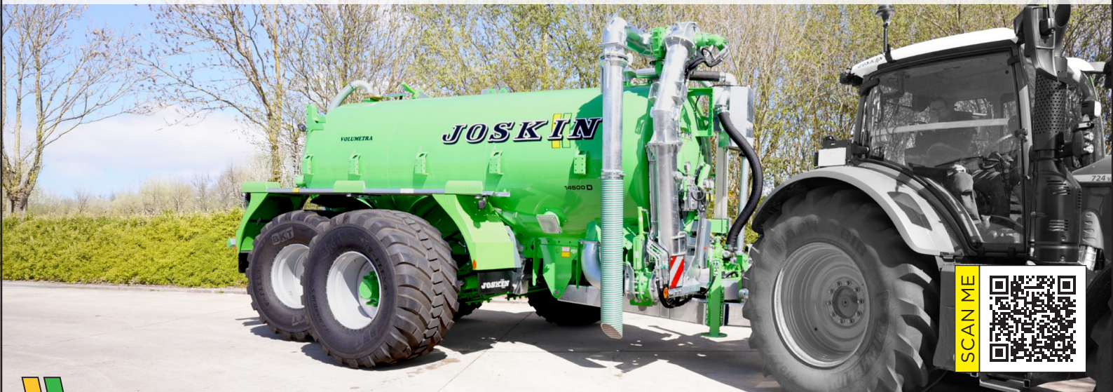
Oś 13 t wydłużana o 700 mm (na osi stałej)
